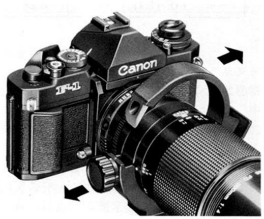
※レンズのAマークセットは、AEロックピンを押下げて行ないますが、Aセットをしますと通常の追針式カメラにはレンズが取付けできなくなります。ご注意ください。なお、Aセットはカメラの使用説明書の指示に従ってください。
