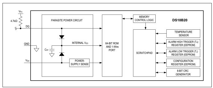
Figure 3. DS18B20 Block Diagram
