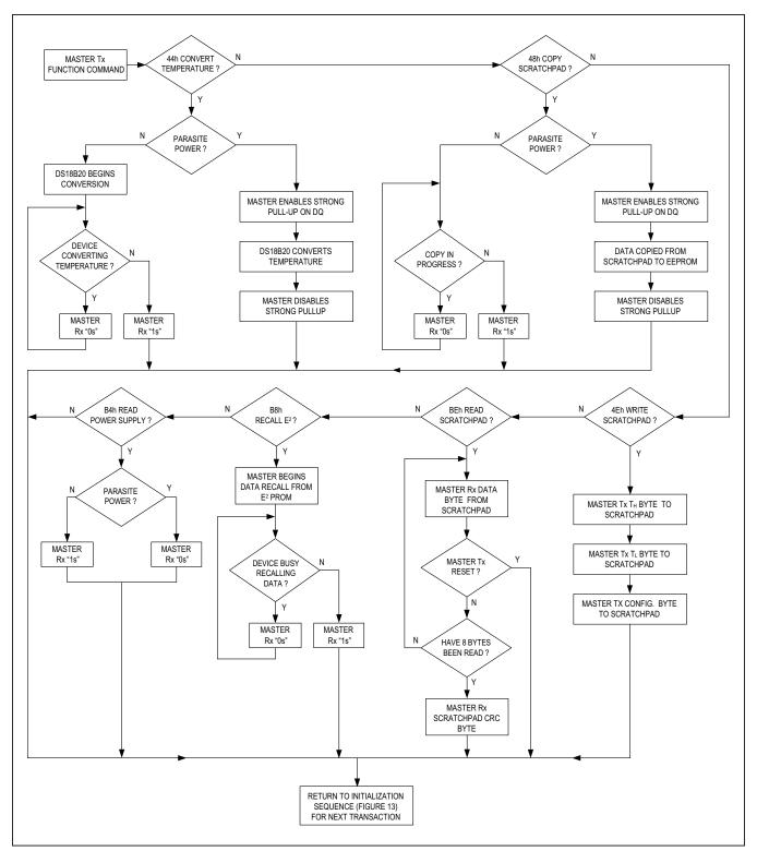
Figure 14. DS18B20 Function Commands Flowchart
