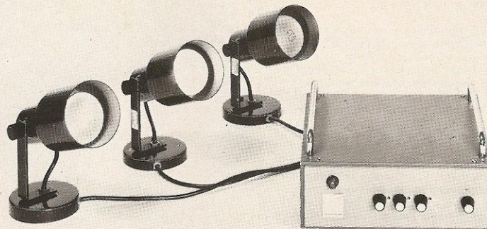
Voorbeeld van inbouw lichtorgel in Montaflexkast.
