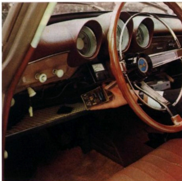
Montage van de tachometer in een zeepdoos onder het dashboard van de auto.
