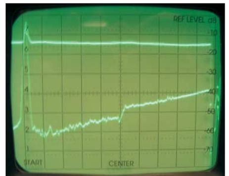
Bild A6: Eingangsanpassung des Detektor-eingangs von 0 bis 200 MHz, 20 MHz bzw. 10 dB pro Teilstrich; die Rückflussdämpfung ist die Differenz beider Kurven und beträgt mit  $R_6 = 68 \Omega$  bis 160 MHz mindestens 28 dB, entsprechend  $r = 0,04$  und  $s = 1,08$ .
